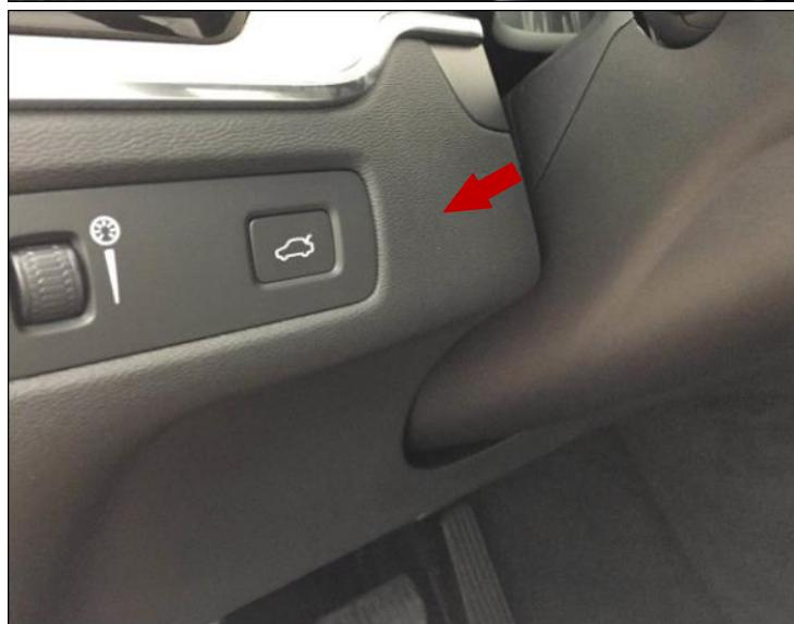
安装开关：开关上的 3M 胶离型纸撕下，开关贴对应位置即可（箭头）
