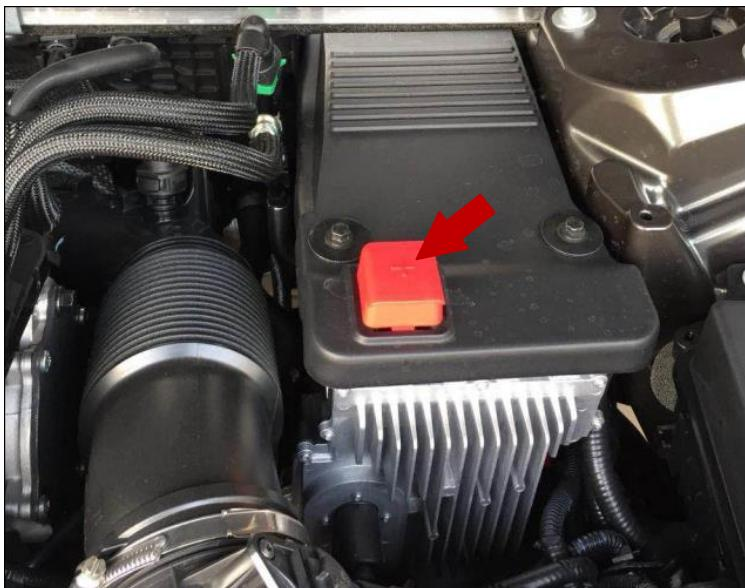
**接正极线：**在车头处找到我们要接的正极电，揭开电源正极盖用我们的红色线接正极电源，(箭头)
